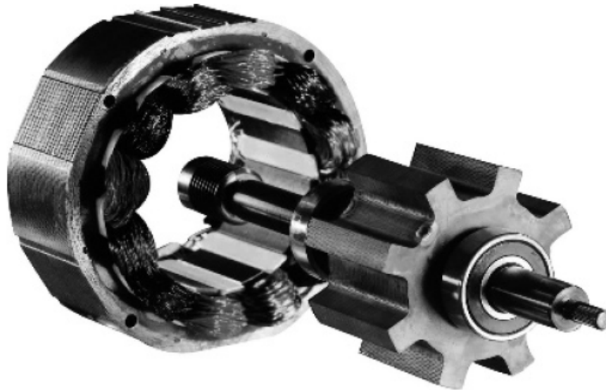
Figura 4-10 - Estator e rotor de um motor de relutância variável de 10/8 pólos [19]
