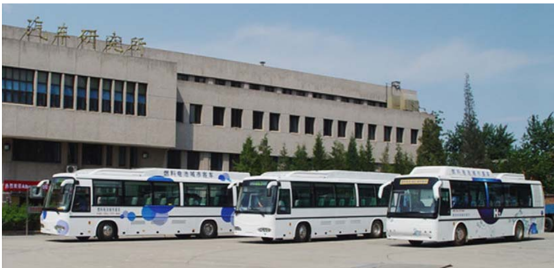
Figura 7-34 - Ônibus elétricos híbridos com pilhas a combustível, desenvolvidos na China [21]
