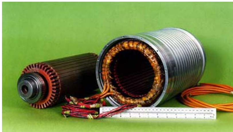
Figura 4-8 - Construção de um motor de indução tipo gaiola de esquilo, [17]
