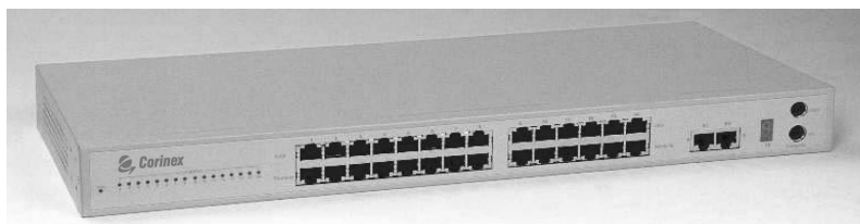
Figura 2.16: Comutador HomePNAv3 Corinex CXH-AV-SWT.
