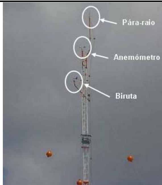
Figura 2.4 – Torre anemométrica, mostrando detalhe do anemômetro e biruta (sensor de direção) montados a 50 m e o pára-raios montado para proteção contra descargas atmosféricas.
