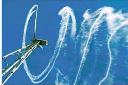
Figura 3.5 - Efeito de sombreamento de uma turbina eólica – fonte: http://www.windpower.org
