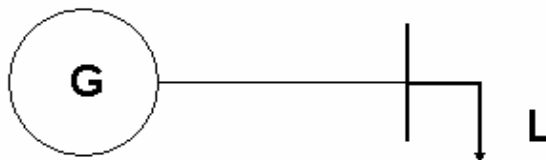
Figura 2.12 – Diagrama do sistema equivalente na análise de confiabilidade de geração
