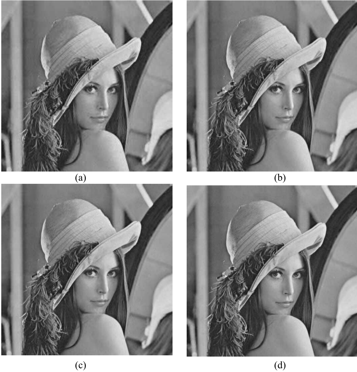
Figura 5.13: Comparação da codificação da Lena 512x512 para diferentes taxas utilizando ACTTCQ-SBC. (a) 0.250bpp (b) 0.375bpp (c) 0.500bpp (d) 0.625bpp.
