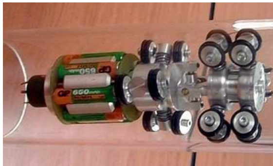
FIGURA 7.13: Arquitetura do sistema robótico D-70/2 (Horodincea et al. 2002)
