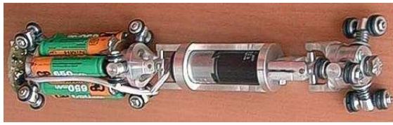
FIGURA 7.11: Arquitetura de três corpos para pequenos diâmetros do sistema robótico D-40 (Horodincea et al. 2002)
