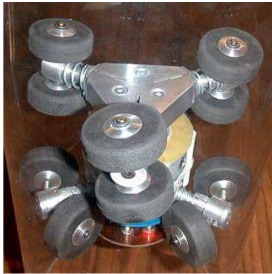
FIGURA 7.10: Arquitetura de dois corpos do sistema robótico D-170 (Horodincea et al. 2002)
