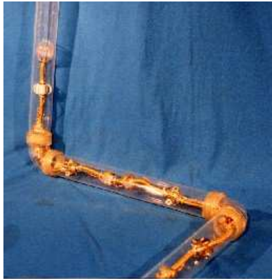
FIGURA 7.6: Sistema robótico THES II inserido dentro de uma tubulação (Hirose et al. 1999)
