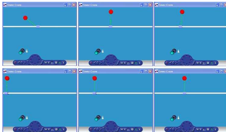
FIGURA 4.10: Carro-pêndulo visualizado pelo toolbox virtual reality do Matlab.
