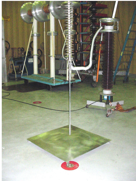
Figura 5.6 – Arranjo ponta-plano para ensaio ao ar livre
