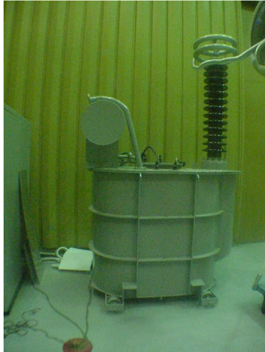
Figura 3.1 – Transformador monofásico 230kV, laboratório CEPEL
