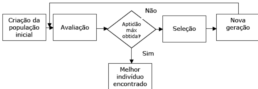
Figura 2.8 - Fluxograma de uma algoritmo genético [15]
