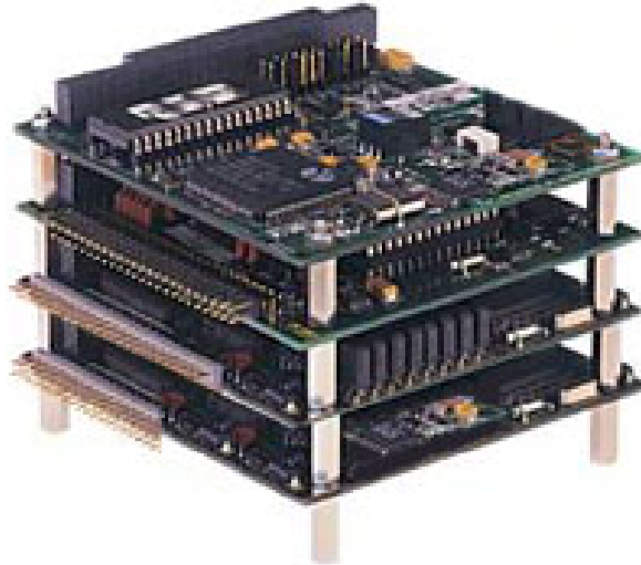
FIGURA 4.3: Computador do tipo PC/104 com módulos adicionais empilhados
