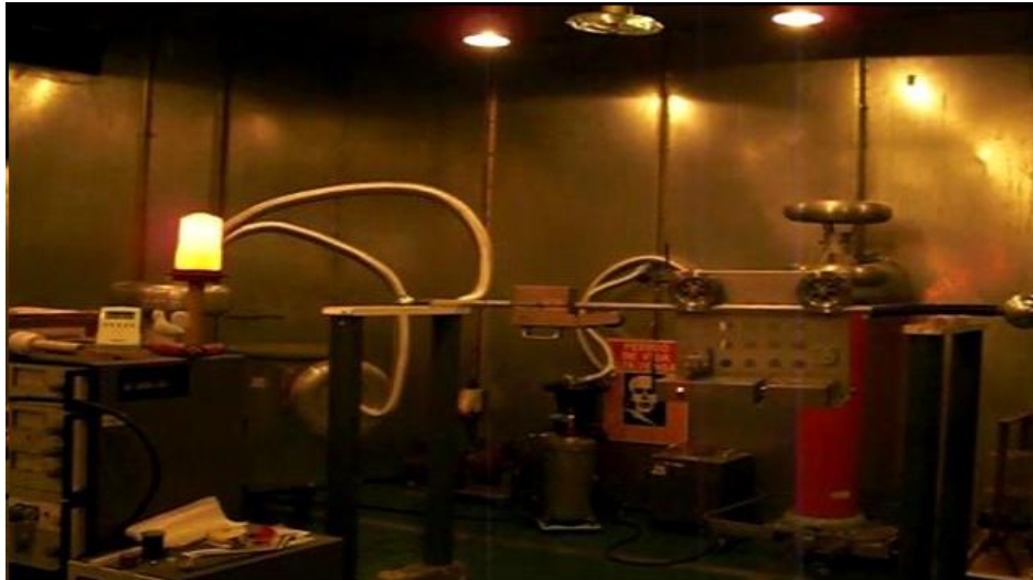
FIGURA 5.24: Teste de interferência no robô submetido a alta tensão e alta corrente elevadas.
