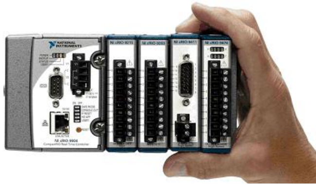
FIGURA 4.5: Vista frontal de um sistema CompactRIO
