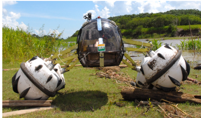
FIGURA 6.25: Configuração do Robô Ambiental Híbrido ao se Deparar com um Obstáculo no Terreno
