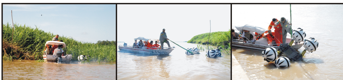
FIGURA 6.4: Tombamento do Robô Ambiental Híbrido Modelo Intermediário
