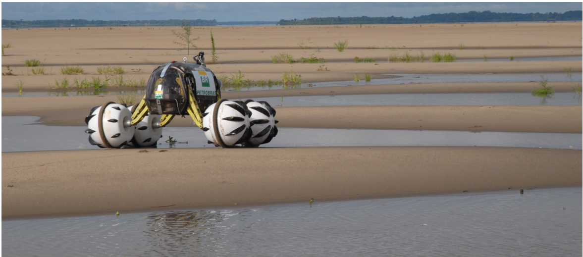
FIGURA 6.33: Robô Ambiental Híbrido ao Percorrer um Banco de Areia Ondulado
