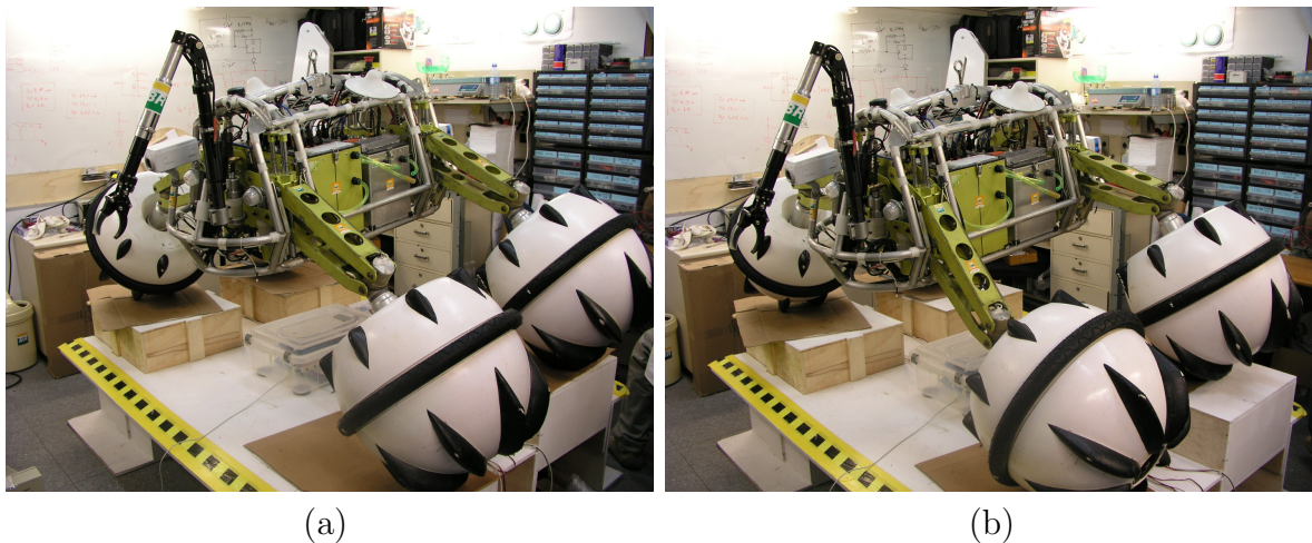
FIGURA 6.21: Robô Ambiental Híbrido em Terreno Plano com Depressão: (a) Sem Controle; (b) Controle de Tração.
