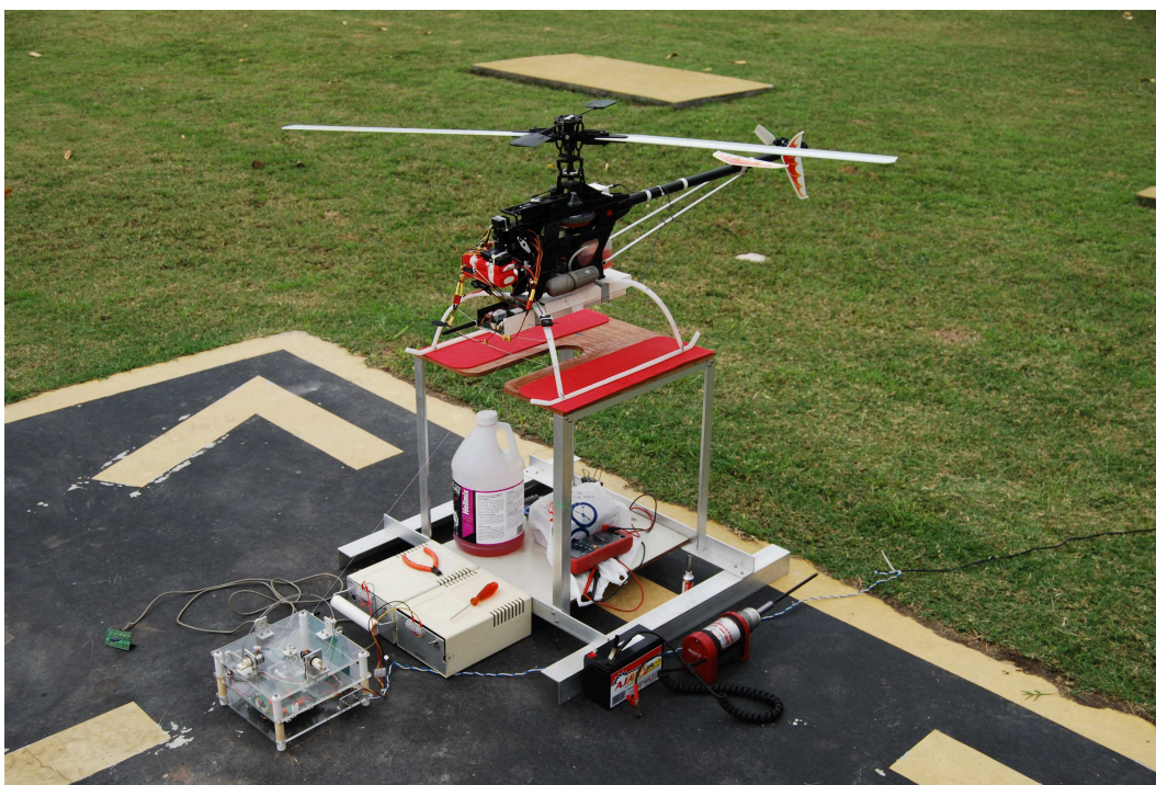
FIGURA 7.3: Helicóptero e sistema montados para a realização dos experimentos.
