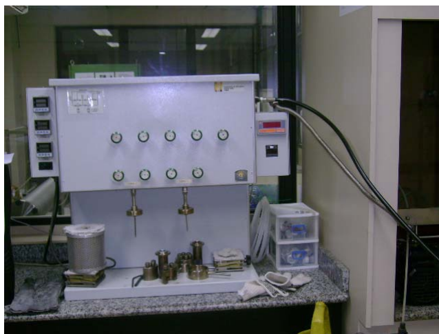
Figura 16: Equipamento Sievert usado na hidrogenação.
