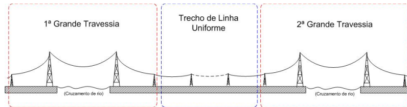
Figura 4.68: Diagrama esquemático de uma grande travessia associada a um trecho de 5,2 km de uma LT trifásica de 230 kV
