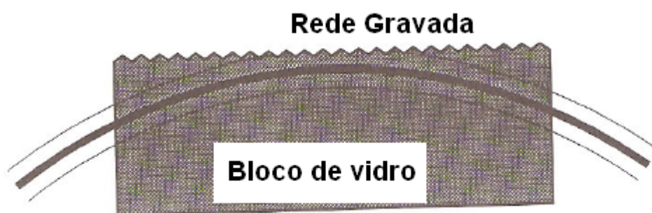
Figura 2.5.1. FBG fabricada por modulações periódicas na superfície (Adaptado de CULSHAW & DAKIN, 1996).
