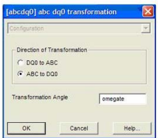
Figura 87: Parametrização do bloco abc-dq do PSCAD EMTDC™ [22].
