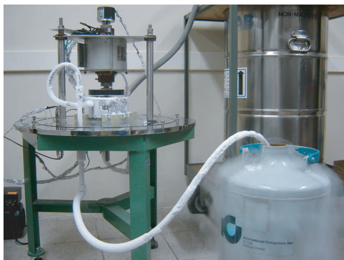
Figura 3.7: Funcionamento da MRV com mancal supercondutor
