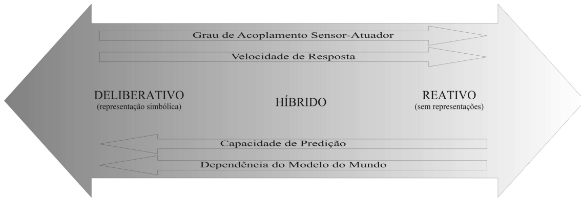
Figura 2.2: Espectro de classificação das arquiteturas de navegação, segundo Arkin [2].
