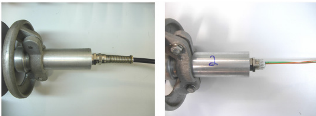
Figura 3.29: Detalhes do isolador óptico, com quatro vias de fibra ótica
