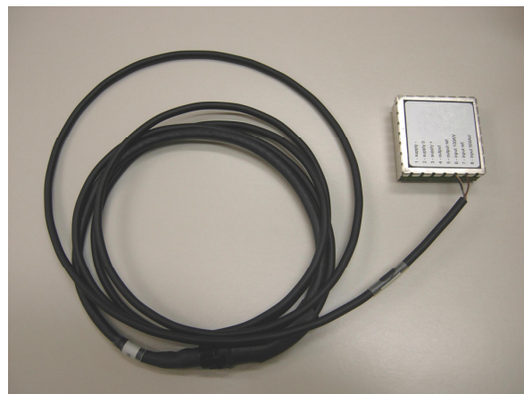
Figura 3.10: Bobina de Rogowski conectada ao circuito integrador
