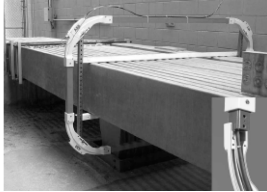
Figura 2.8: Sensor de corrente em fundição de alumínio (adaptado de BOHNERT et al. [26])
