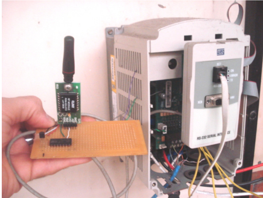
Fig. 25: Módulo receptor (RXM) acoplado ao hardware do inversor CFW-09.
