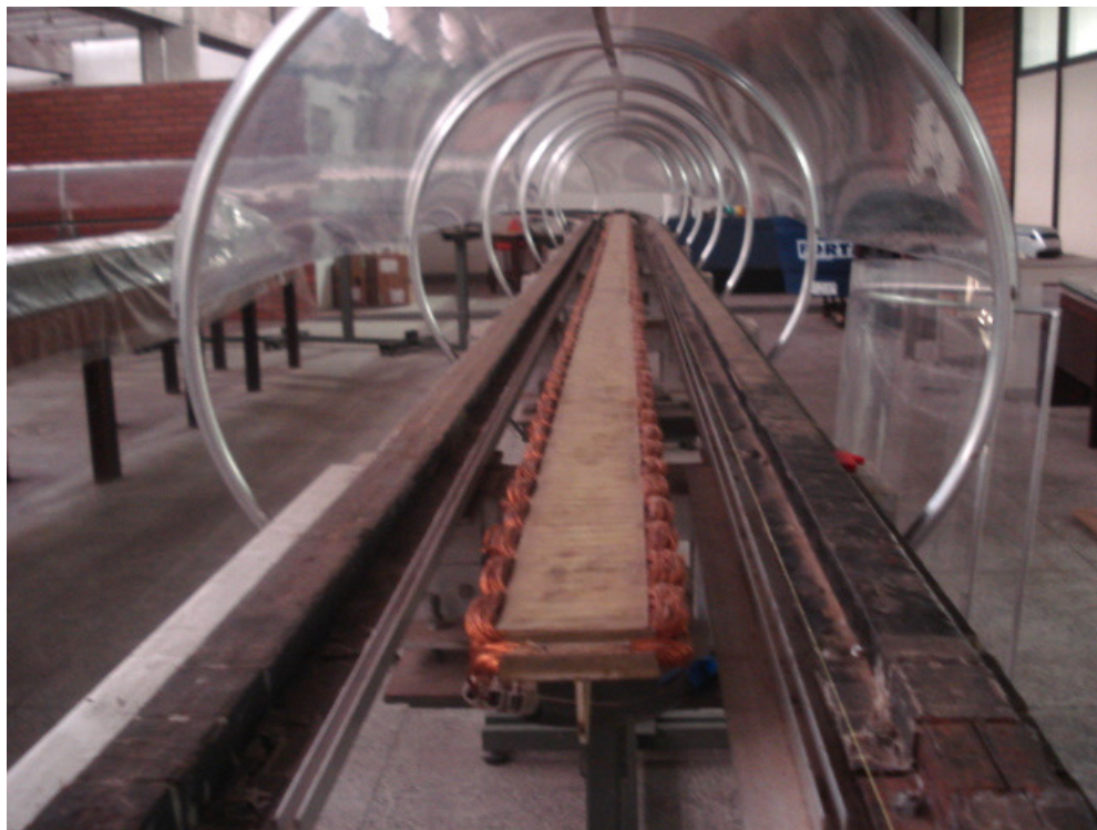
Fig. 3: Imagem de um trecho no início do motor linear de primário longo do LASUP.
