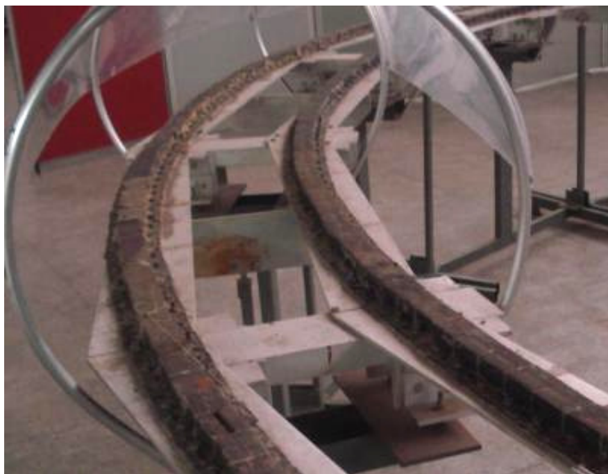
Fig. 7: Detalhe de construção do trilho de ímãs do protótipo.
