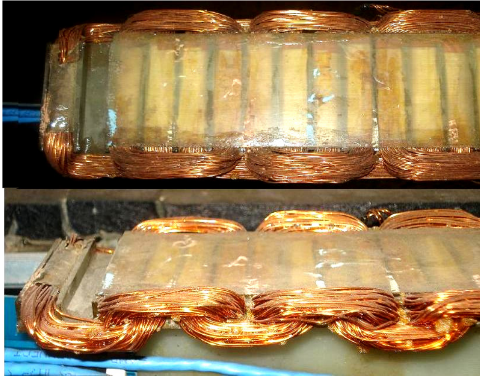
Fig. 9: Imagem em detalhe do motor linear síncrono de primário longo. Acima a vista superior e abaixo a vista lateral.
