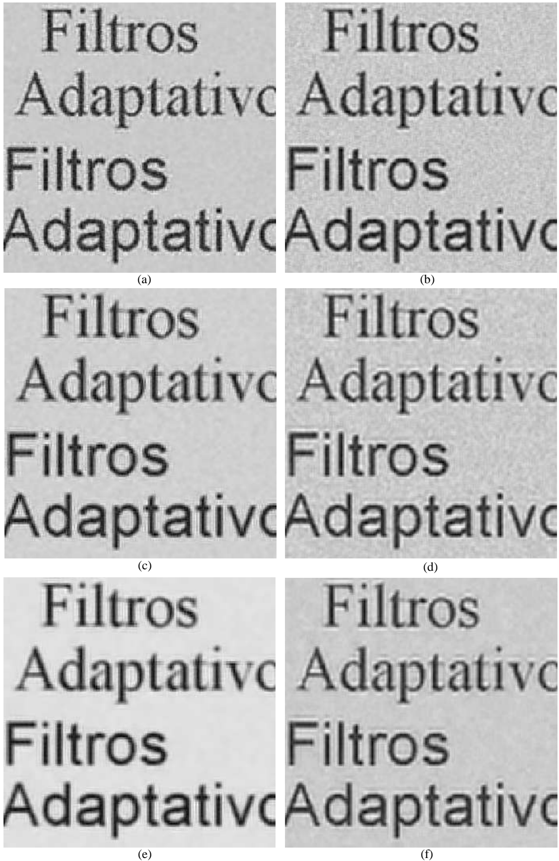
Figura 4.19: Imagens Super-resolução de texto com ruído \sigma^2 = 0,05 : (a) Filtragem de Wiener; (b) Filtragem adaptativa; (c) Filtragem de Wiener e Wavelet; (d) Filtragem adaptativa e Wavelet; (e) Filtragem de Wiener, Wavelet e denoising ; (f) Filtragem adaptativa, Wavelet e denoising .
