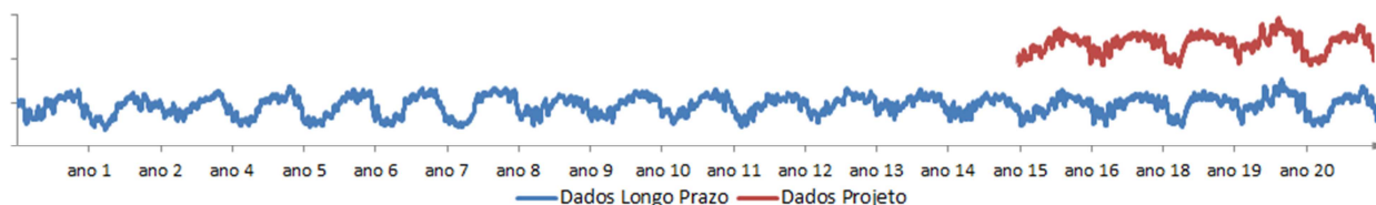
Figura 1.6 – Dados medidos no local do projeto e dados de longo prazo medidos em uma estação de referência com períodos coincidentes.
