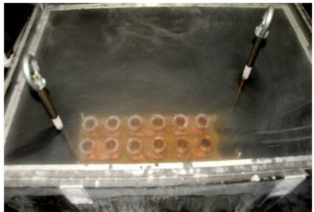
Figura 5.4: Imersão em nitrogênio líquido para os a) limitadores da Família A e para b) os limitadores da Família B.
