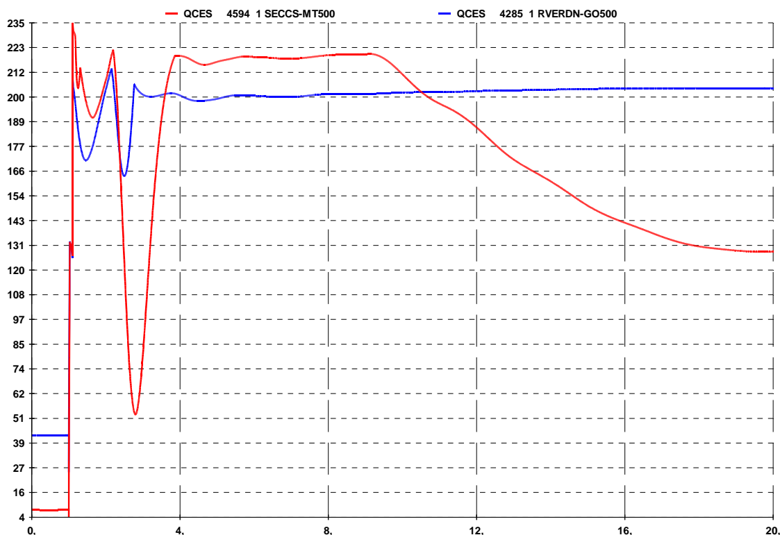
Figura 73 – Comportamento das Potências Reativas em Mvar dos Compensadores estáticos das SEs Seccionadora Sul e Rio Verde Norte – 2020 Completo.
