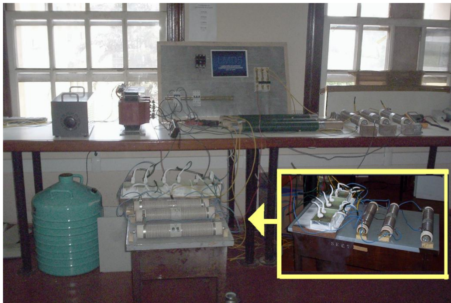
Figura 40 – Bancada de testes do limitador no LMDS-UFRRJ [1].
