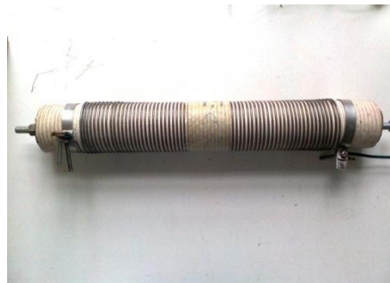
Figura 42 – Resistor utilizado como carga nos ensaios realizados no LMDS-UFRRJ.
