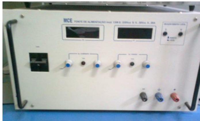
Figura 45 – Fonte de corrente utilizada no levantamento da corrente crítica (CC) da amostra supercondutora utilizada na UBS.
