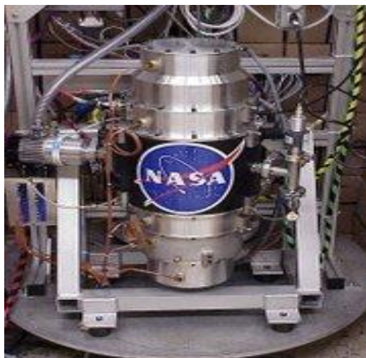
Figura 69 – Protótipo de SMES desenvolvido pela NASA [35].
