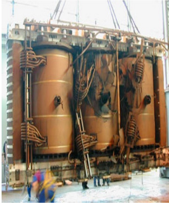
Figura 2.7 – Parte ativa de um transformador trifásico de 418 MVA-550 kV
