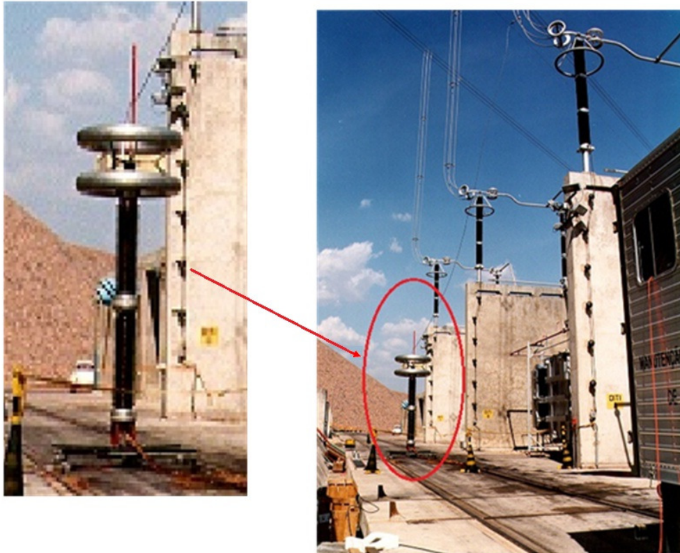
Figura 3.12 – Divisor capacitivo utilizado para a medição
