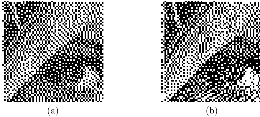
Figura 4.10: Simulação do bloco 64 \times 64 : (a) algoritmo ideal no MATLAB e (b) simulação elétrica no SPICE.
