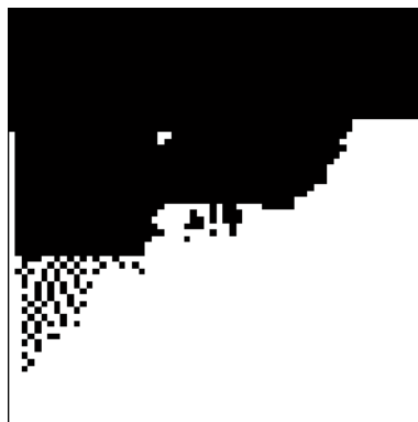
Figura 4.13: Os pixels na região escura estão estáveis após 80 \mu\text{s} de simulação e os na região clara ainda sofrem transições.
