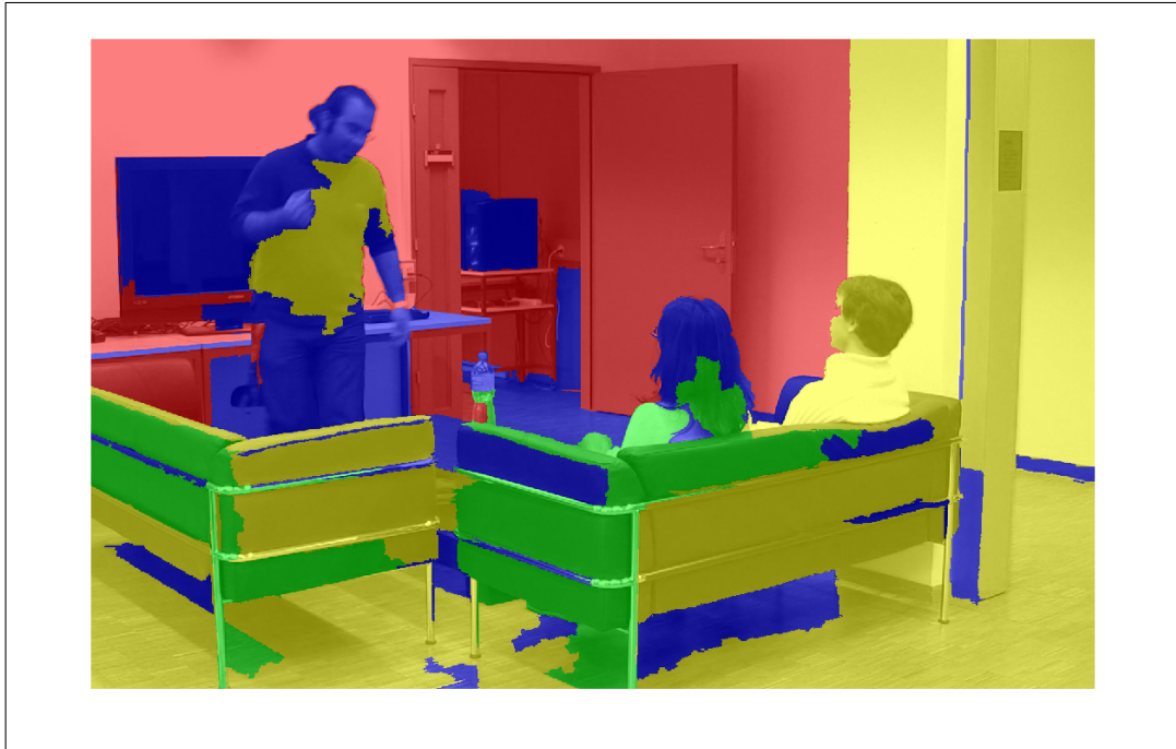
Figura 3.6: Imagem da figura 3.4 com as regiões CVR em verde, as regiões DIV em vermelho, as regiões NCVR em amarelo e as regiões sem classificação em azul.
