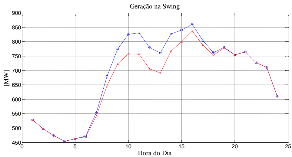
Figura 55: Sistema sem (azul) e com (vermelho) geração fotovoltaica.
