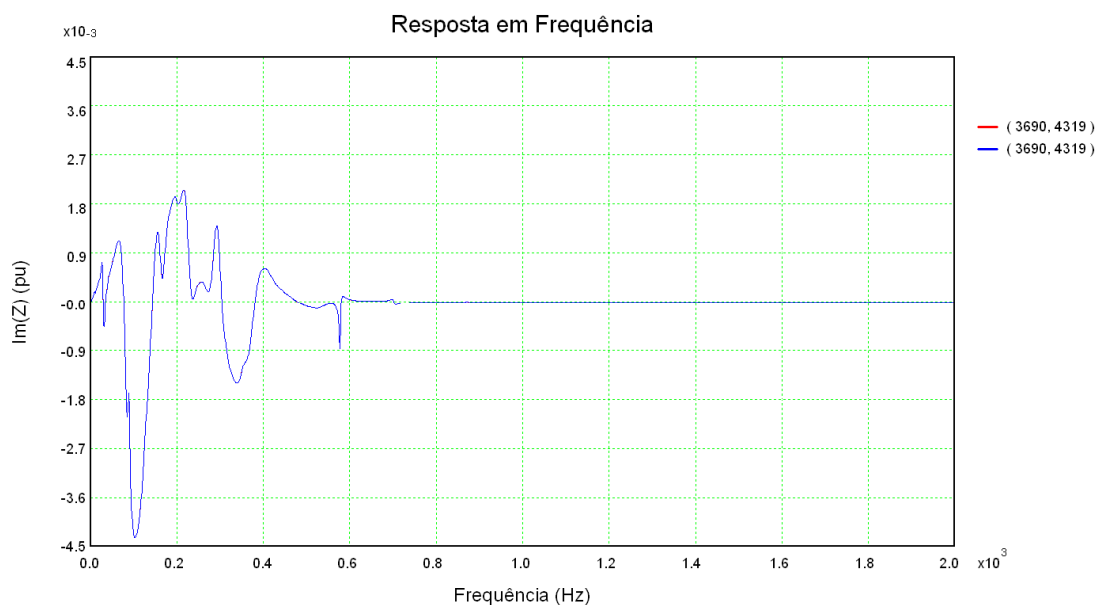
Figura 208: Resposta em frequência da parte imaginária da impedância de transferência entre as barras 3690 e 4319 considerando a rede completa (vermelho) e o sistema reduzido considerando o equivalente modal (azul)
