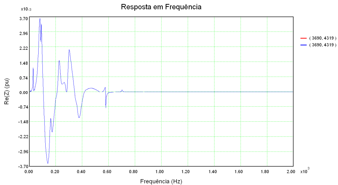
Figura 247: Resposta em frequência da parte real da impedância de transferência entre as barras 3690 e 4319 considerando a rede completa (vermelho) e o sistema reduzido considerando o equivalente modal (azul)
