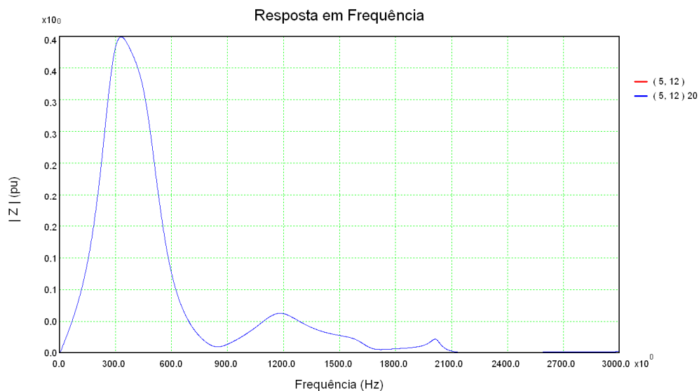
Figura 66: Resposta em frequência do módulo da impedância de transferência entre as barras 5 e 12 considerando a rede externa completa (vermelho) e a rede externa modelada por polos e resíduos (azul)
