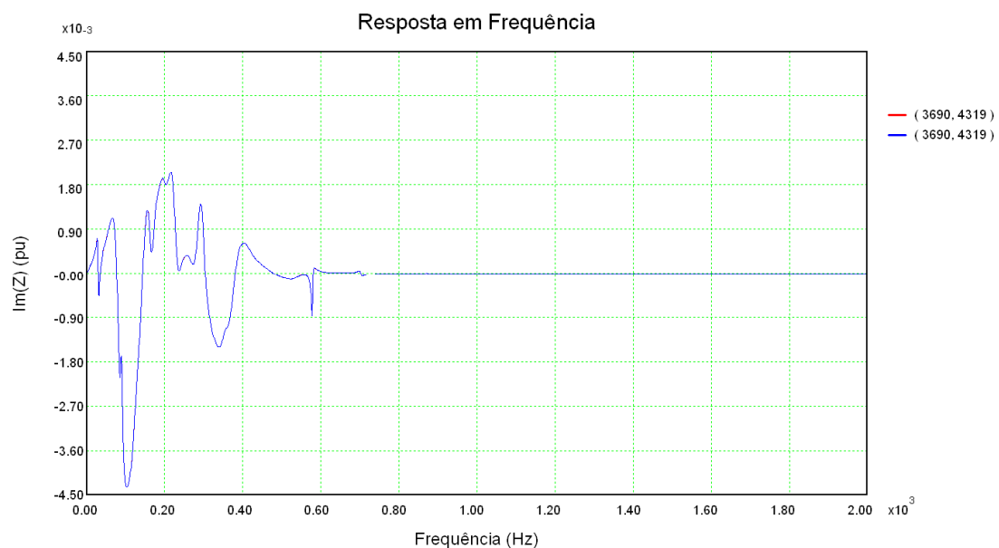
Figura 248: Resposta em frequência da parte imaginária da impedância de transferência entre as barras 3690 e 4319 considerando a rede completa (vermelho) e o sistema reduzido considerando o equivalente modal (azul)
