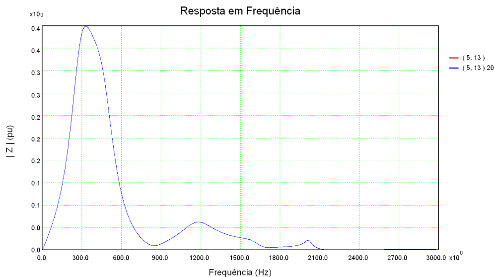
Figura 68: Resposta em frequência do módulo da impedância de transferência entre as barras 5 e 13 considerando a rede externa completa (vermelho) e a rede externa modelada por polos e resíduos (azul)
