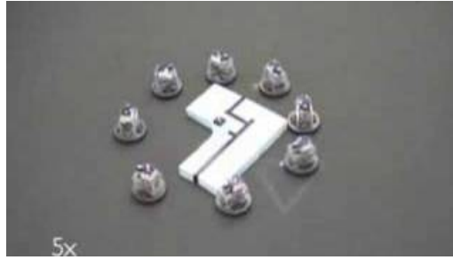
Figura 1.16: Exemplo de transporte de carga utilizando enjaulamento. O objeto pode se mover dentro da circunferência de robôs, mas não pode sair deste espaço 2 .
