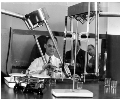
Figura 1.3: Primeiro dispositivo de teleoperação, descrito por Goertz em 1954. O acoplamento entre mestre e escravo é mecânico, através de um mecanismo de quatro barras. Retirado de (Niemeyer et al. 2008)
