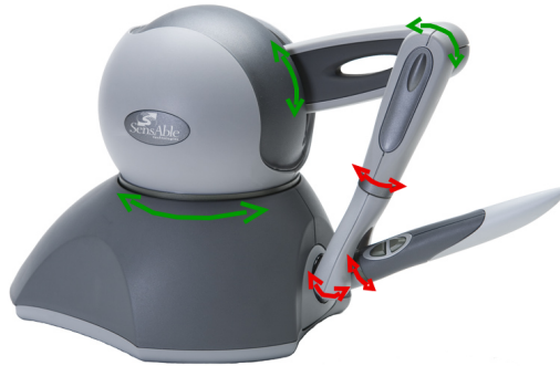
Figura A.8: Phantom Omni com os eixos de rotação indicados. Em verde as juntas atuadas e em vermelho as não atuadas.
