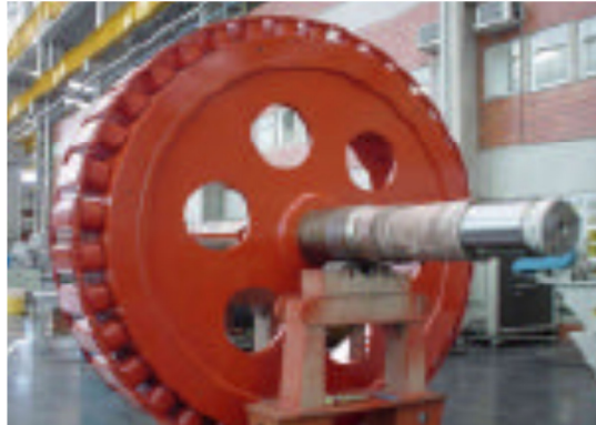
Figura IV-2 – Gerador Síncrono com polos salientes
