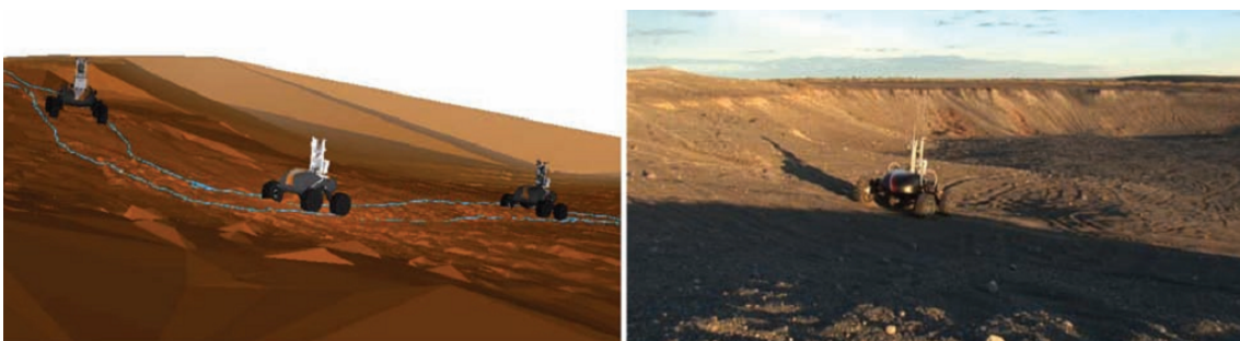
Figura 3.1: Modelagem de terreno por robô móvel através da triangulação de Delaunay (Wettergreen et al., 2010). O robô possui um laser range finder e constrói um modelo em tempo real.
