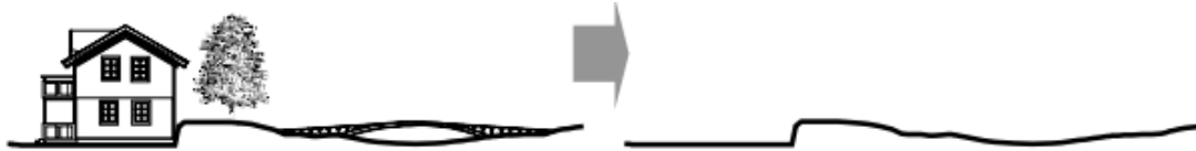
Figura 2.5: Filtragem de vegetação por escaneamento aéreo realizado por Sithole and Vosselman (2003).
