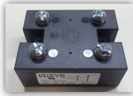
Figura 41 - Ponte retificadora monofásica VBO 125-12N07.
