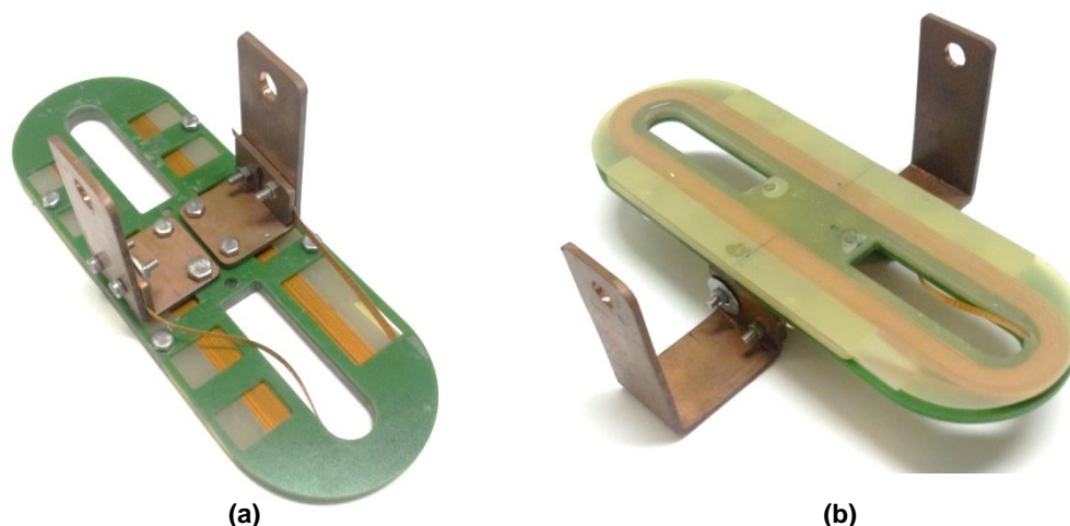
Figura 38 - Bobinas supercondutoras de Fitas 2G com terminais tipo L (a) e L-invertido (b)
