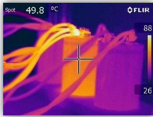
Figura 58 - Análise térmica dos capacitores após adaptação técnica.
