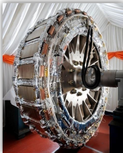
Figura 15 - Foto do rotor supercondutor do Hydrogenie .
