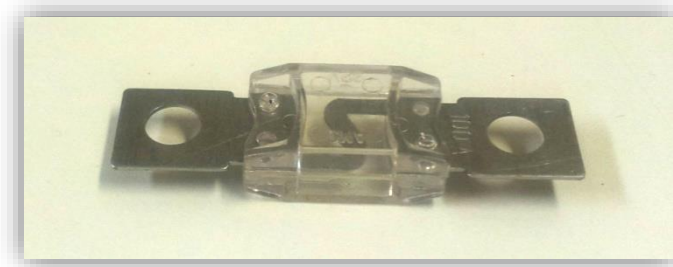
Figura 48- Fusível utilizado na proteção do terceiro estágio.
