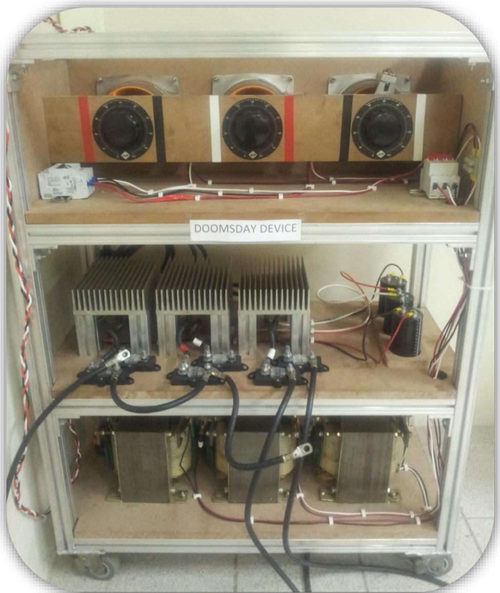
Figura 49 – Montagem da fonte retificadora.
