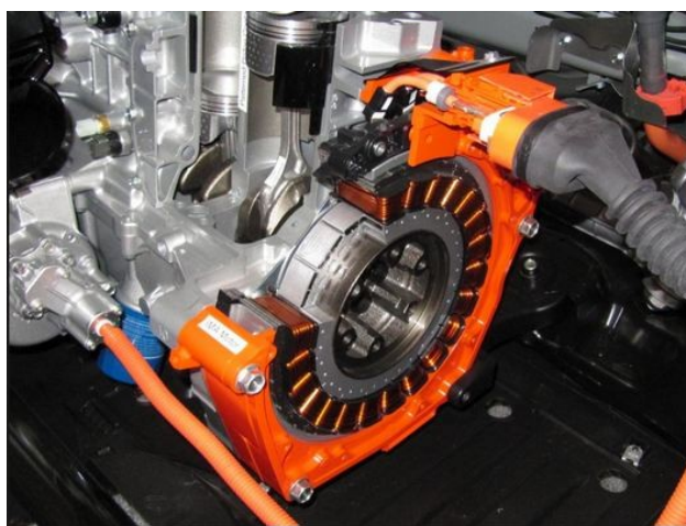
Figura 1.6. Exemplo de ISG do Honda Civic Hybrid 2012 (VOELCKER, 2011).
