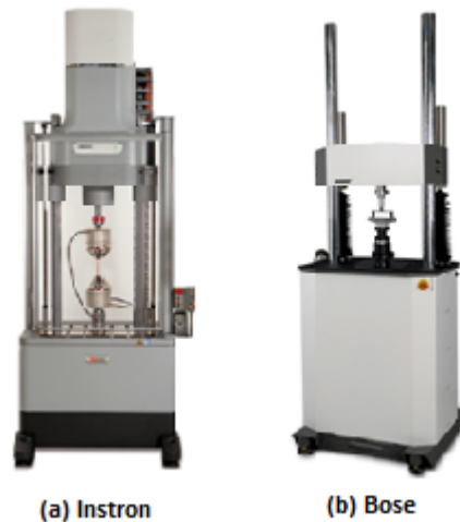
Figura 2.6: Soluções comerciais de máquinas de fadiga acionadas por motores lineares, a) solução comercial disponibilizada pelo site comercial da INSTRON e, b) disponibilizada pela BOSE.
