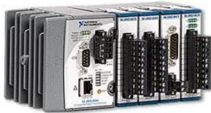
Figura 2.17: Controladora NI-CRIO9014. Apresenta funções para controle com tempo determinístico Real Time e paralelismo real FPGA . (Fonte: www.ni.com )
