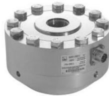
Figura 2.15: Célula de carga para medição de força sobre o CP. (Fonte: www.hbm.com )
