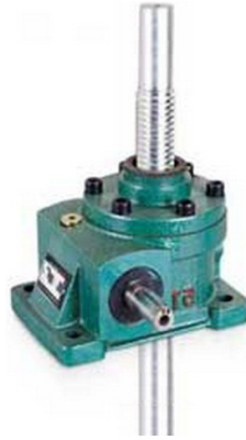
Figura 2.20: Sistema de redução da máquina eletromecânica. Transforma o movimento angular do motor elétrico em linear vertical por meio de um sistema de engrenagens.
