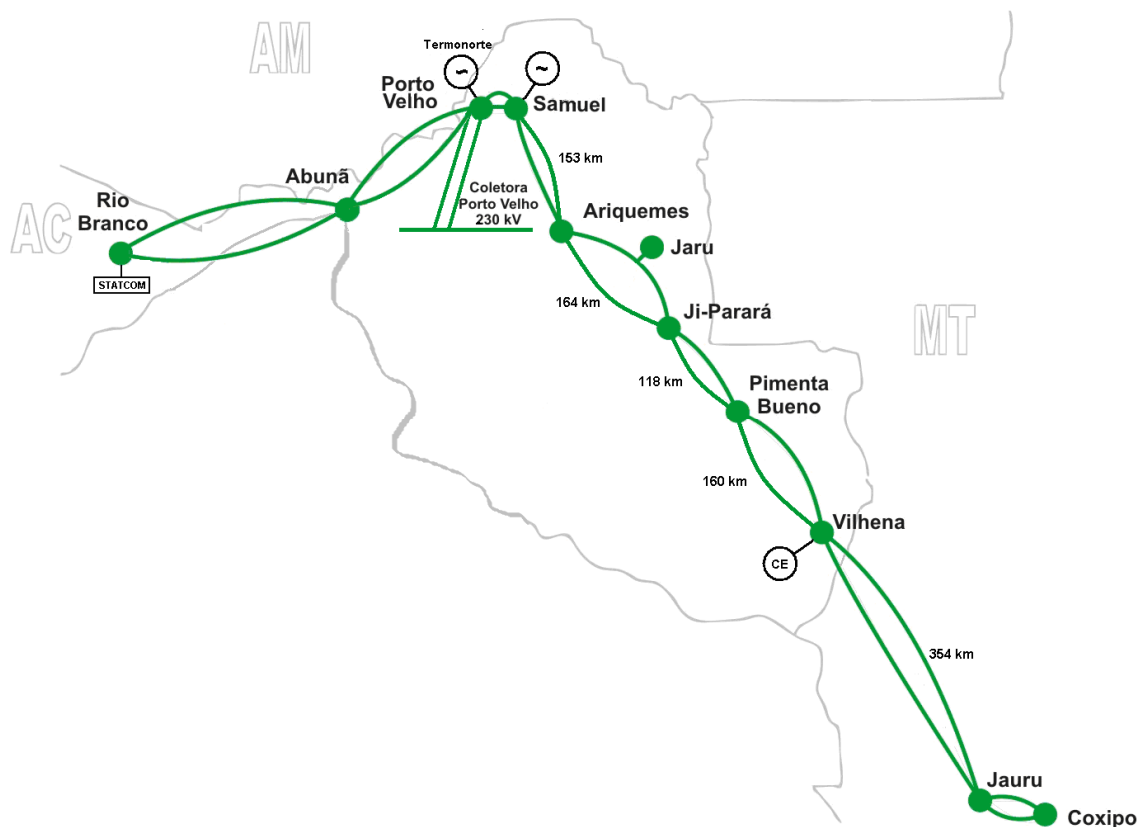
Figura V.1-1 – Diagrama geoeletrico da área Acre e Rondônia (Fonte: ONS)
