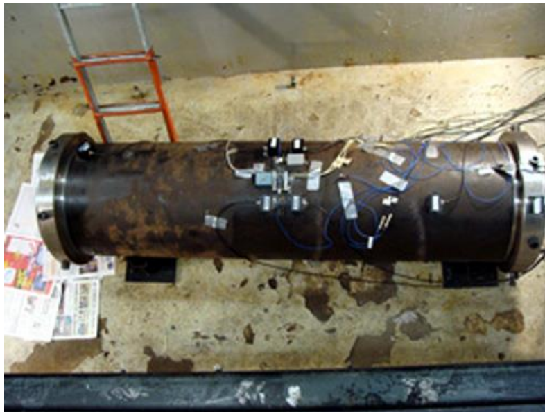
Figura 26. Duto de 2m de comprimento instrumentado [18].
