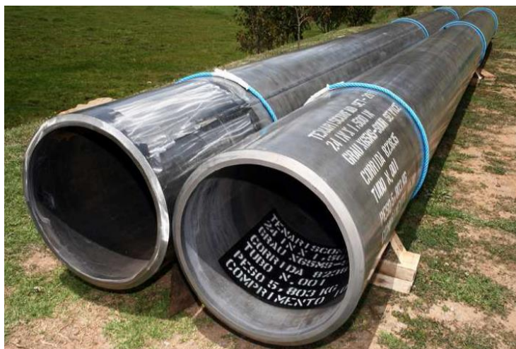
Figura 2. Tubo rígido com costura. Fonte: Palestra de Instalações Submarinos.
