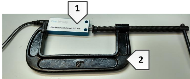
Figura 6.4 – Vista do sensor com a haste deslocada. Na figura: (1) sensor com haste deslocada e (2) sargento segurando haste do sensor.
