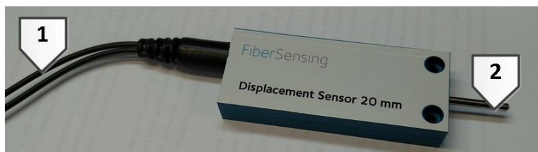
Figura 6.1 – Visão do sensor de deslocamento. Na figura: (1) Cordão óptico e (2) haste de medição.
