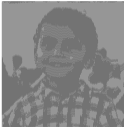
(b) FSVQ com R = 1 bpv, projetado com base em VQ de 6 bpv sem memória;
