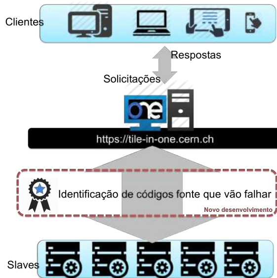
Figura 3.2: Esquemático representando a infraestrutura da plataforma Tile-in-ONE. Em vermelho, a nova camada a ser desenvolvida.
