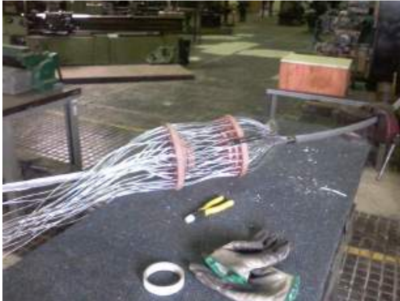
Figura 3.7. Amostra do cabo com os separadores instalados e suas camadas ainda desencordoadas.
