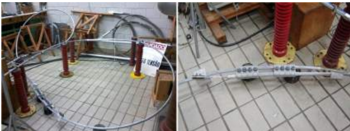
Figura 3.17. Parte traseira do arranjo com o fechamento do laço formado pelo cabo, em detalhe (à direita) os grampos de conexão paralelos fechando o laço.
