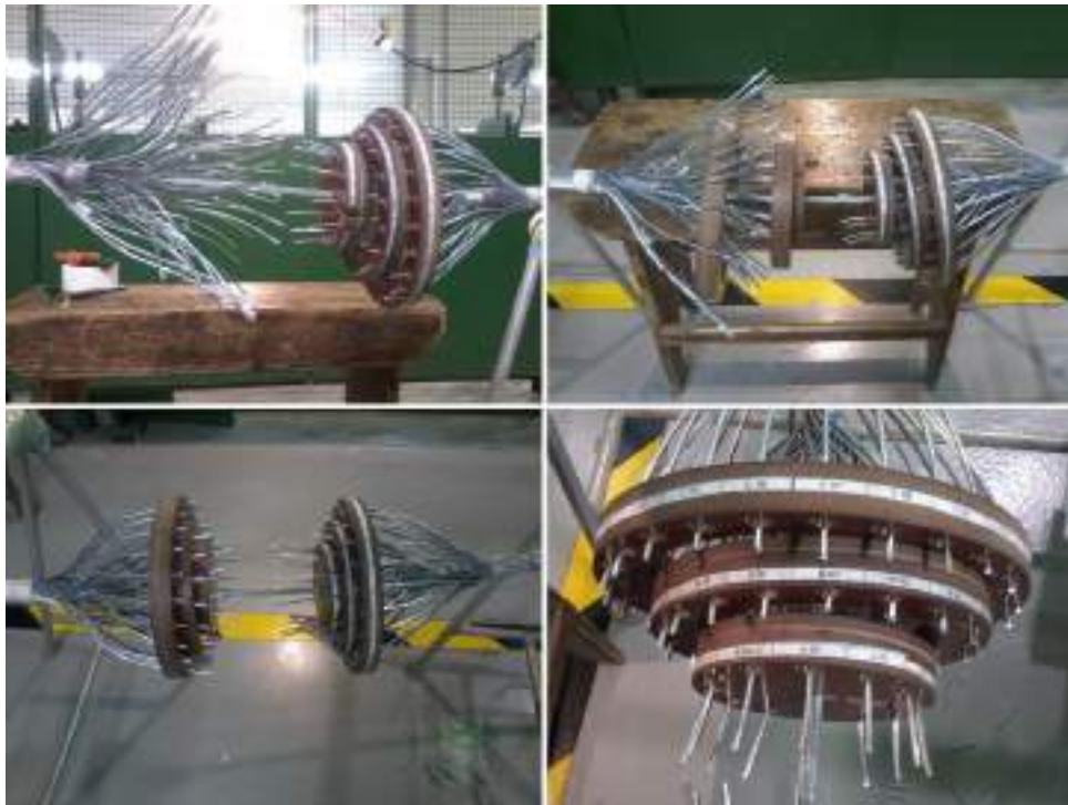
Figura 3.12. Várias etapas da instalação dos separadores, em detalhe no último quadro.
