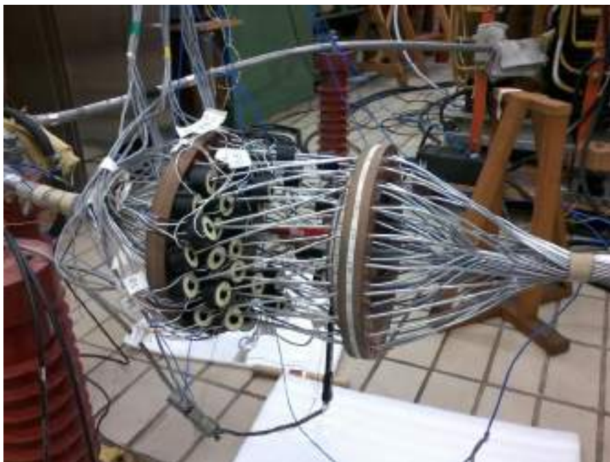
Figura 3.15. Detalhe do arranjo utilizado no ensaio, com os separadores e sensores de corrente.
