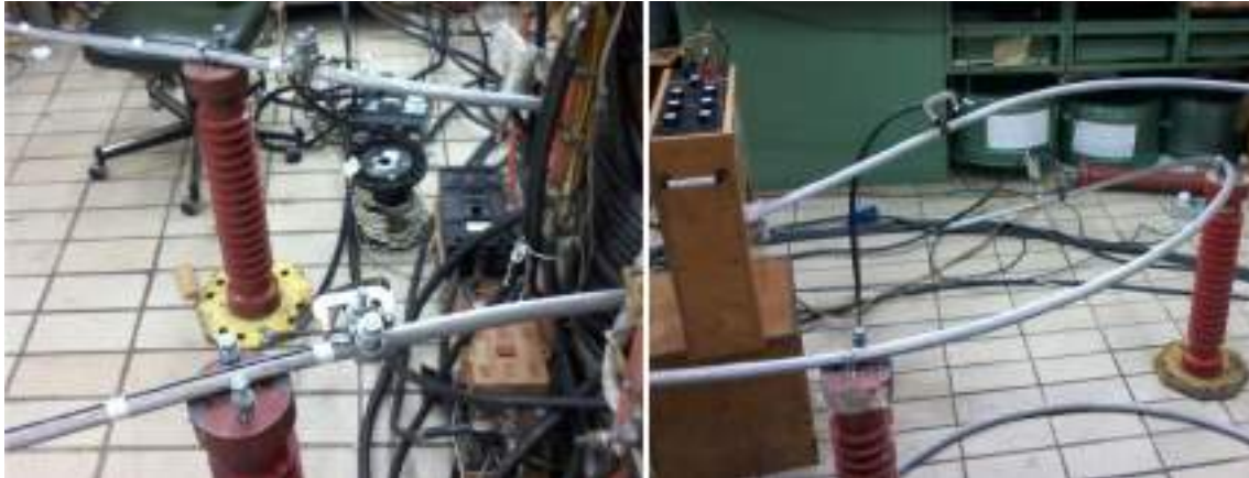
Figura 3.5. Detalhe dos terminais para medição de tensão (à esquerda) e de injeção de corrente (à direita).
