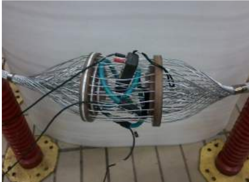
Figura 3.10. Instalação das bobinas de Rogowski sobre as camadas internas e intermediárias e o transformador de corrente do tipo alicate envolvendo apenas o núcleo de aço.
