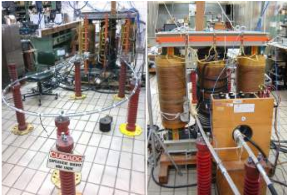
Figura 3.4. Parte frontal e traseira do arranjo utilizado para o levantamento do fator R_{ac}/R_{dc} do cabo Duck .
