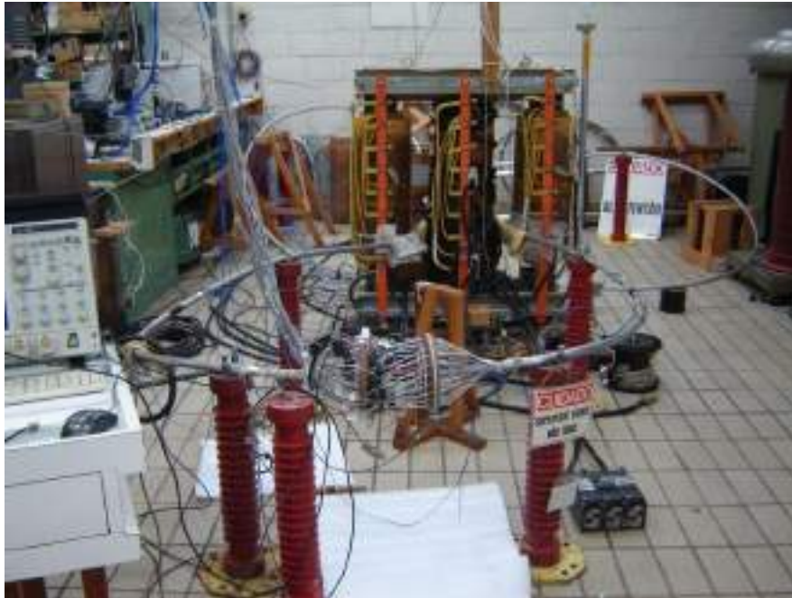
Figura 3.14. Arranjo utilizado no ensaio para a medição da distribuição de corrente do cabo Duck .
