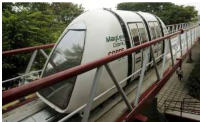
Figura 4.2: Protótipo do trem de levitação magnética, MagLev-Cobra , desenvolvido pela Coppe/UFRJ (Foto: Arquivo próprio).
