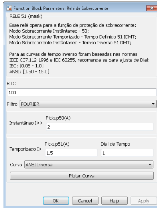
Figura 4. 9 Parametrização do relé de sobrecorrente
