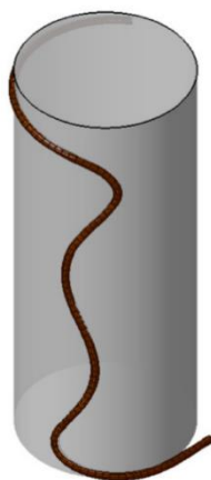
Figura 2.11 – Fibra óptica posicionada na ranhura de um cilindro para que seja realizada a reconstrução do formato da fibra em três dimensões espaciais [28].
