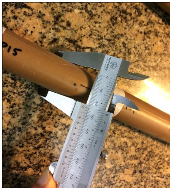
Figura 5.9 – Medição do diâmetro do tubo de PVC para o ponto P14.
