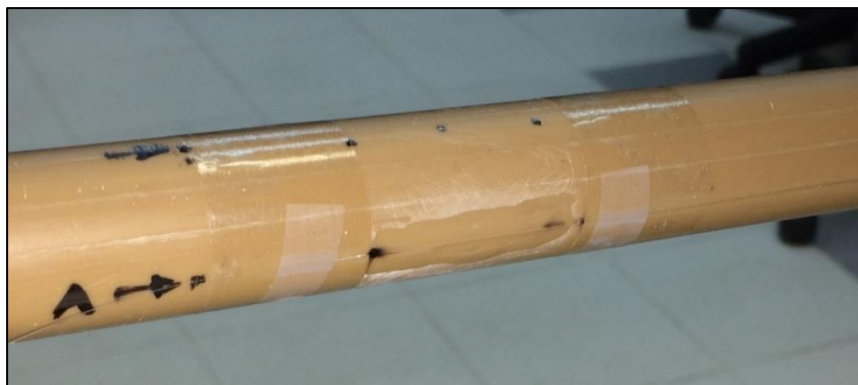
Figura 5.10 – Resultado de um exercício de colagem de sensor óptico utilizando a cola Loctite 496. Sensor alinhado pela direção indicada através da seta A.
