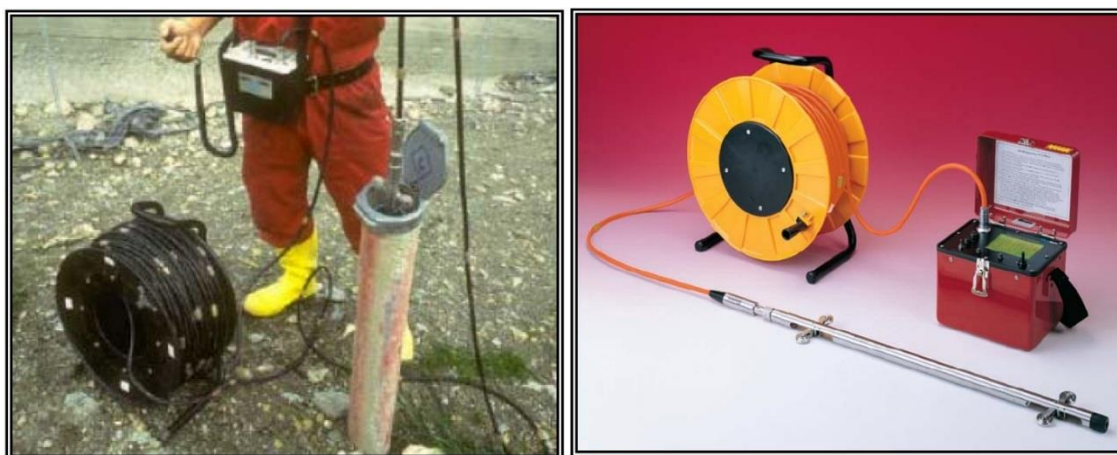
Figura 1.2 – Exemplo de um sistema de monitoramento de torpedo com inclinômetro [4].
