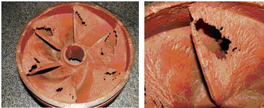
Figura 5 - Bomba danificada em decorrência da cavitação. Fonte: Extraído de Coelho (2006).
