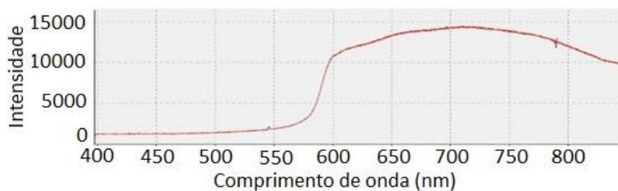
Figura 24 - Espectro de uma lâmpada halógena
