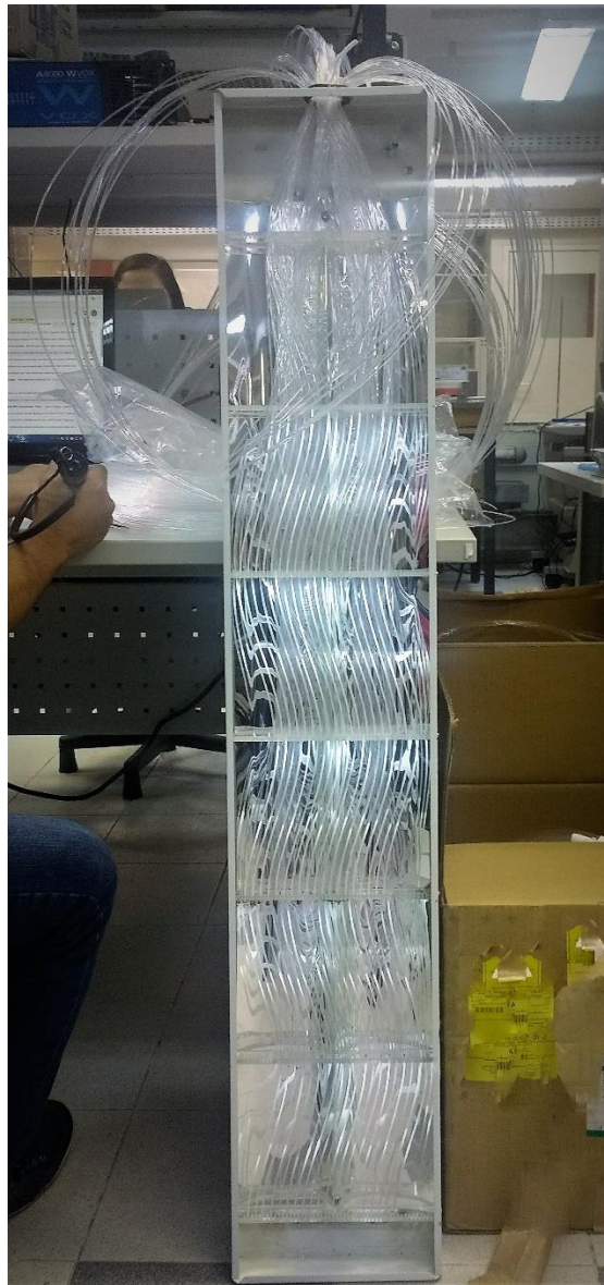
Figura 30 - Luminária difusa sendo montada com as fibras ópticas
