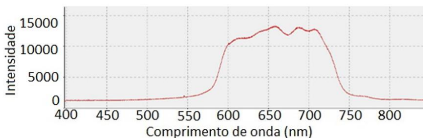
Figura 25 - Espectro de uma lâmpada halógena após o filtro infravermelho
