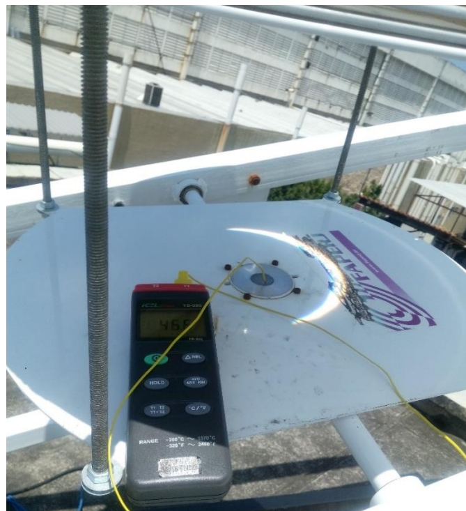
Figura 19 - Medida de temperatura do feixe com termopar
