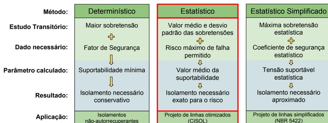
Figura 5.2: Métodos de coordenação de isolamento.
