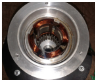
Figura 3.2: Vista superior do protótipo de Tipo B, de quatro pólos.
