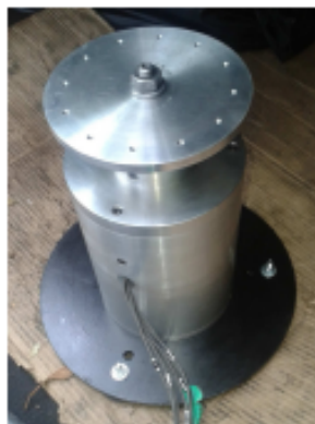
Figura 3.3: Conjunto montado: rotor vertical com disco perfurado inserido em uma das carcaças.
