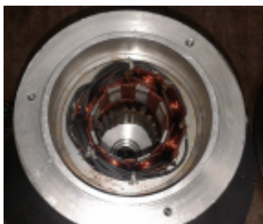
Figura 3.1: Vista superior do protótipo de Tipo A, de oito pólos.
